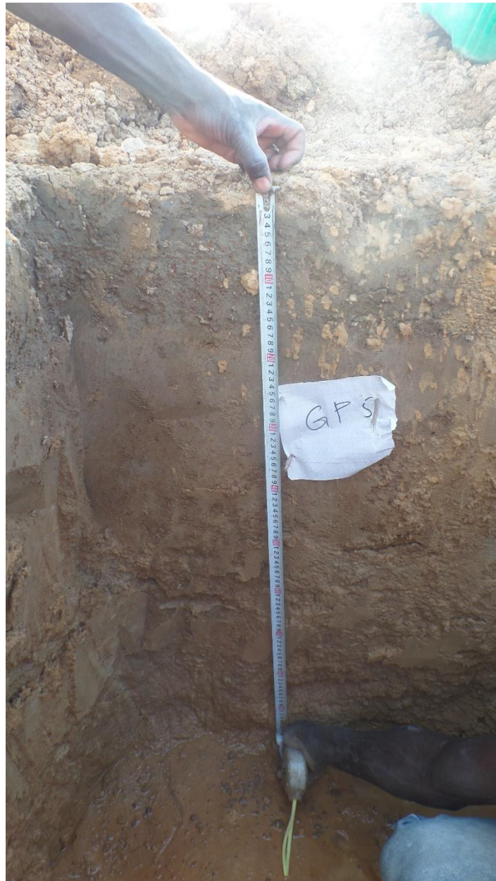
Photo 5 - Profil du sol au point P5 - de 0 à 20 cm : concrétions argilo-limoneuses dans une matrice d'argile grise ; de 20 cm en bas de profil : zone légèrement indurée correspondant à la zone à argile tachetée.
