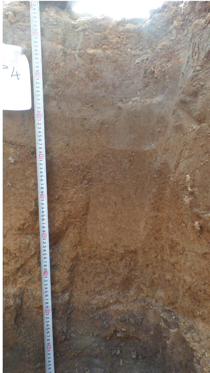
Photo 4 - Profil du sol au point P4 - de 0 à environ 35 cm : argile grise ; de 35 à 80 cm : correspond à la zone à argile tachetée d'un profil d'altération classique ; zone
