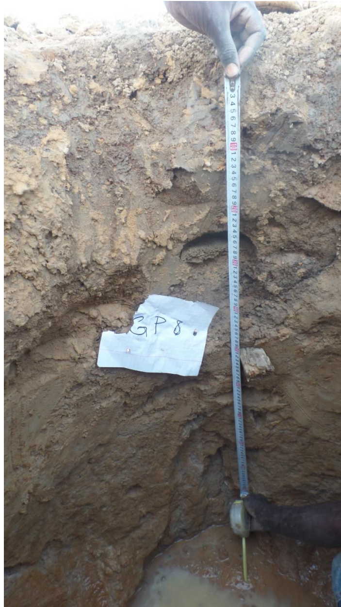
Photo 7 - Profil du sol au point P8 : de 0 à 50 cm : argile grise (sombre) ; de 50 cm à 100cm : zone à argile tachetée légèrement indurée.
